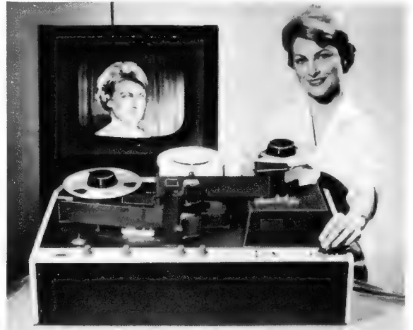
Nur 59 kg schwer und mit den Abmessungen eines größeren Handkoffers präsentiert sich das neue tragbare Video-Bandaufzeichnungsgerät VR 1500 von Ampex
