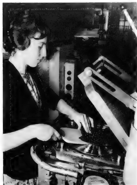
Bild 3. Füllen der Presse mit der Kunststoffmasse
