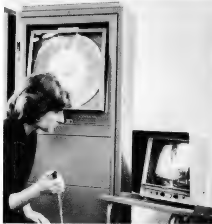
Bild 5. Beim Betätigen eines Druckschalters werden die Bildsignale eines von der Fernsehkamera aufgenommenen laufenden Vorganges auf der rotierenden Speicherfolie, links im Drehrahmgestell, magnetisch aufgezeichnet und auf dem Sichtgerät als stehendes Bild wiedergegeben; die Folie ist hier zum Sichtbarmachen hochgeschwenkt, im Betrieb liegt sie waagerecht, vgl. Bild 6
