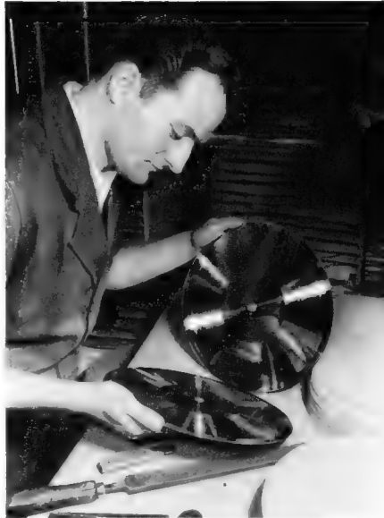
Bild 2. Die Metallmatrix wird von der Folie gelöst
