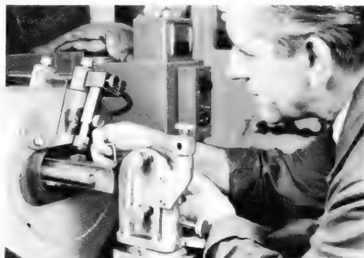
Diamant-Innensäge zum Schneiden von Siliziumtabletten aus Siliziumstäben im Apparatewerk München der Siemens-Schuckert-Werke
