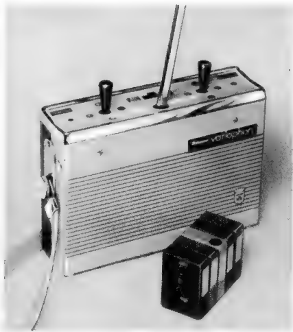
Bild 2. Sender Variophon mit aufgesteckter Teleskopantenne; davor befindet sich der nach dem Bausteinprinzip zusammensetzbare Empfänger Varioton, bestehend aus einem Grundbaustein und vier Schaltstufen. Der Sender besitzt auf der Bedienungsplatte zwei Steuerknüppel, mit denen maximal acht Kommandos gegeben werden können, davon jeweils zwei gleichzeitig
